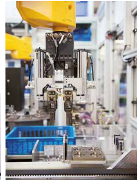
Handhabung der Bauteile aus Stapleinheit und Ladung der Spritzzelle mit Robotern
