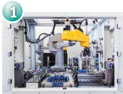
Handhabung der Bauteile aus Stapleinheit und Ladung der Spritzzelle mit Robotern
