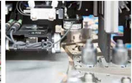
Automatischer Rundtakter mit 100% Kameraprüfungen » Höchste Prozesssicherheit
