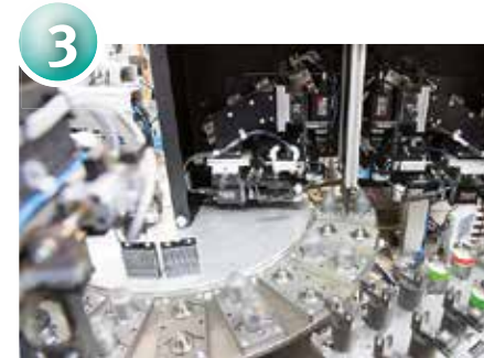
Automatischer Rundtakter mit 100% Kameraprüfungen » Höchste Prozesssicherheit
