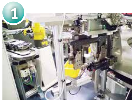
Handhabung, Montage und Prüfung der Gelenke mit einer Taktzeit unter 12 Sekunden
