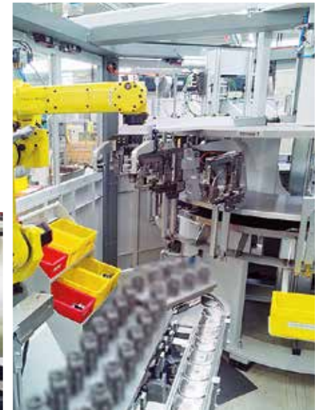
Handhabung, Montage und Prüfung der Gelenke mit einer Taktzeit unter 12 Sekunden
